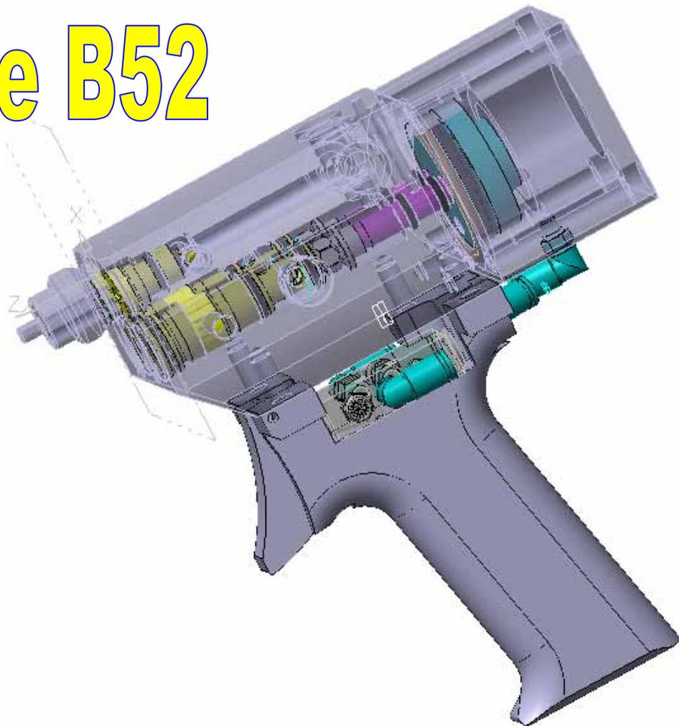
***Sviluppato nel campo del applicazione delle resine bicomponenti, ma capace di integrarsi in diversissimi settori, il B52 è un dosatore capace di gestire in modo indipendente la portata di due flussi in pressione, con la possibilità di creare all' uscita del prodotto una depressione regolabile, in modo da escludere qualsiasi rischio di perdita o gocciolamento del prodotto erogato.***
